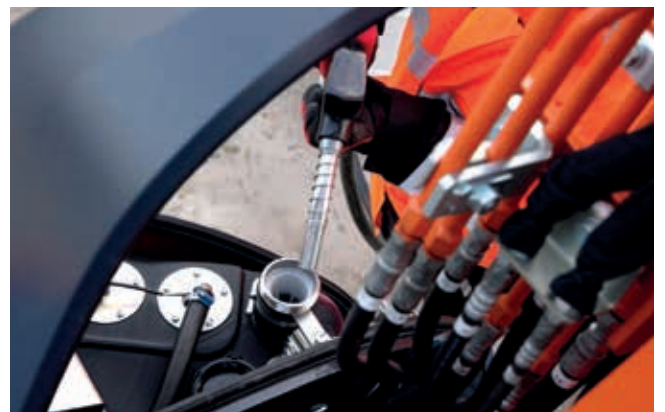
Le réservoir de carburant a également été repositionné pour faciliter et sécuriser le remplissage.
