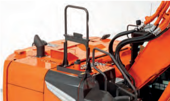
La nouvelle main courante du ZX225US/USR-7 est escamotable, ce qui assure un transport aisé.
